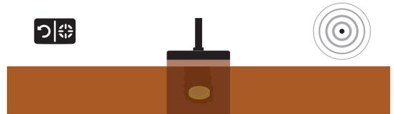
5) Wiederholen Sie den obigen Vorgang, indem Sie die Richtung um 90° ändern. Aktionen, die aus verschiedenen Richtungen durchgeführt werden, schränken den Objektbereich ein und liefern Ihnen die genauesten Details des Objektortes.
