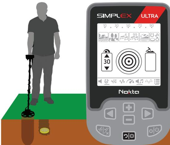
2) Halten Sie die Taste gedrückt und bringen Sie die Suchspule langsam und parallel zum Boden näher an das Objekt.
