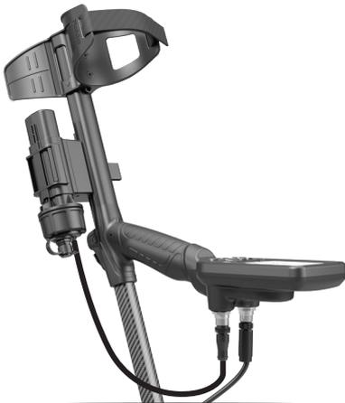
Das Batteriefach läuft mit 4 AA-Alkalibatterien oder wiederaufladbaren NiCd- oder MiMH-Batterien.
