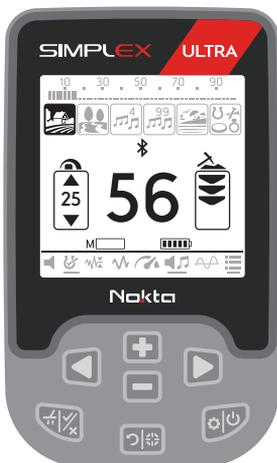
11) Bei der Objekterkennung können Sie die genaue Position des Objektes bestimmen, indem Sie die PP-Taste (pinpoint) drücken und gedrückt halten. Dadurch steigt die Lautstärke des Audiosignals und auch die Tonhöhe nimmt zu, wenn Sie sich dem Objekt nähern.
