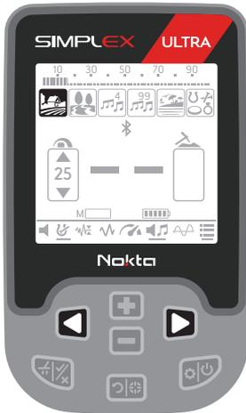
4) Sie können die Empfindlichkeit bei Bedarf erhöhen. Die Erhöhung der Empfindlichkeit bietet Ihnen eine hörere Tiefenleistung. Wenn jedoch die Umgebung oder der Boden übermäßige Störgeräusche im Gerät verursacht, müssen Sie die Empfindlichkeitseinstellung verringern.
